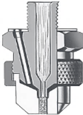
Схематическое изображение внутреннего устройства форсунки
