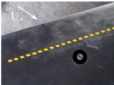
Рис. 1. Фотография модели крыла с установленными элементами шероховатости.
