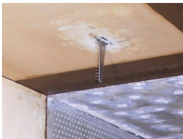
Рис. 1. Гребёнка приёмников полного давления (26 насадков, 20 см в длину), установленная на верхней стенке сопла АДТ Т-128 ЦАГИ.
