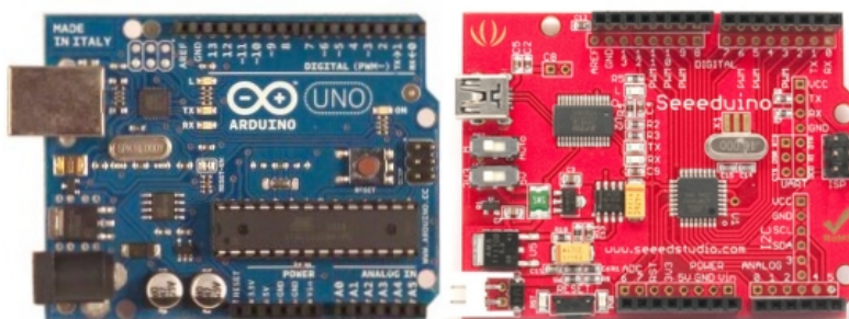
Рис. 1. Arduino (слева) и Seeeduno v2.21 – пример Arduino-совместимой архитектуры
