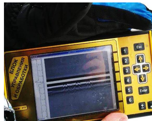
Рис. 6. Проведение эксперимента с резиновым шлангом и показания георадара АБ-1000М
