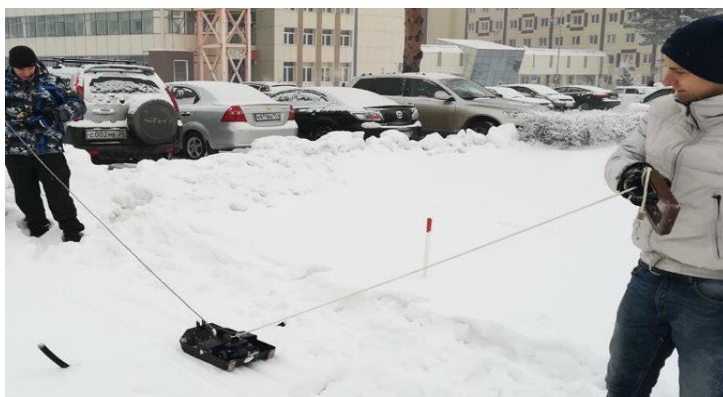
Рис. 6. Проведение эксперимента с резиновым шлангом и показания георадара АБ-1000М
