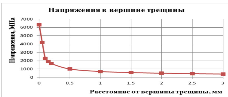
Рис.8. Диаграмма распределения напряжений в вершине трещины
