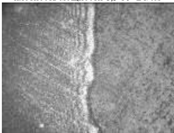
(в) – импульсная энергия 40 мДж, плотность мощности 5,7 \cdot 10^7 Вт/см 2
