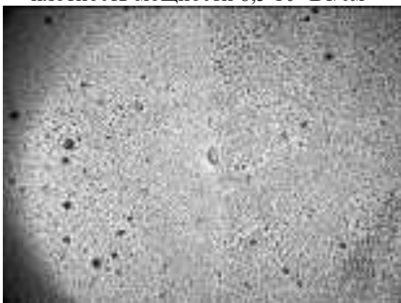
(в) – импульсная энергия 40 мДж, плотность мощности 5,7 \cdot 10^7 Вт/см 2
