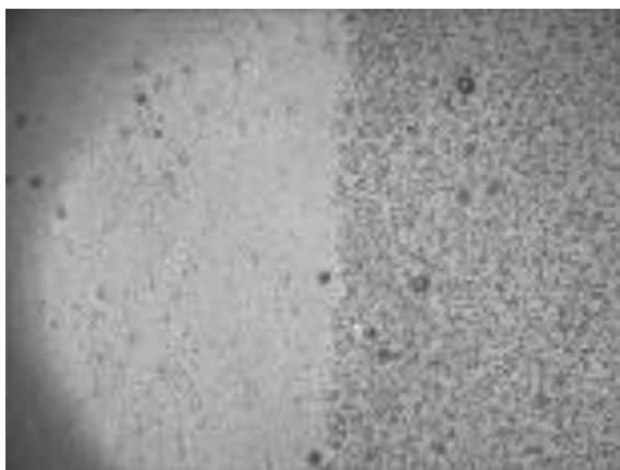
(а) – импульсная энергия 80 мДж, плотность мощности 1,1 \cdot 10^8 Вт/см 2
