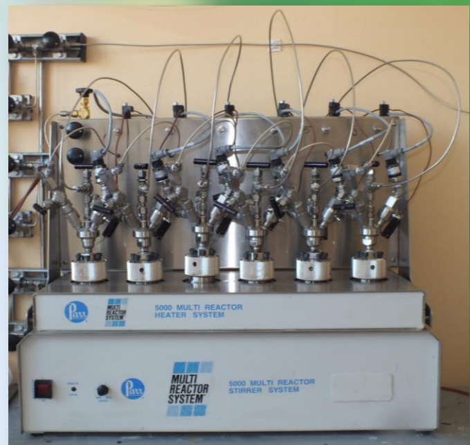
Реактор, используемый для гидрирования ЛК (Parr Series 5000 Multiple Reactor System).
