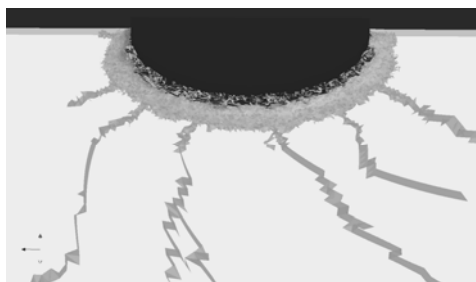
Рис. 13. Картина разрушения ледяного поля при столкновении с опорой.
