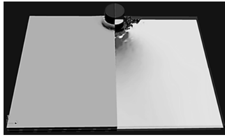
Рис.7. Картина напряжений во льду (компонента \sigma_{yy} при начальной скорости льда, направленной вдоль оси y ).
