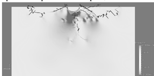
Рис. 10. Области разрушения и картина напряжений льда.
