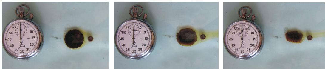
Рис. 2. Лабораторный эксперимент по обтеканию модели диапира окружной формы.
