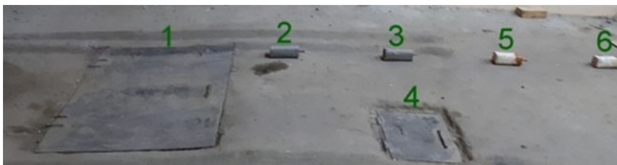
Рис. 2. Расположение образцов вдоль движения георадара
