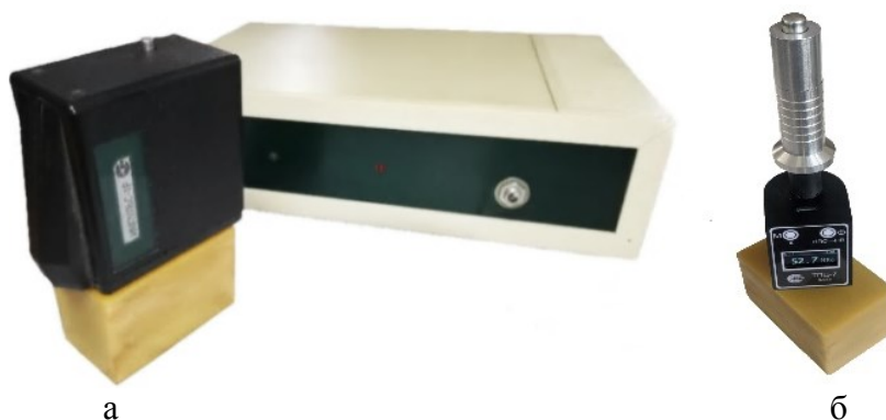
Рис. 1. Динамическое контактное индентирование образца стеклопластика на приборах «Импульс – 1Р» (а) и «ТПЦ – 7» (б)
