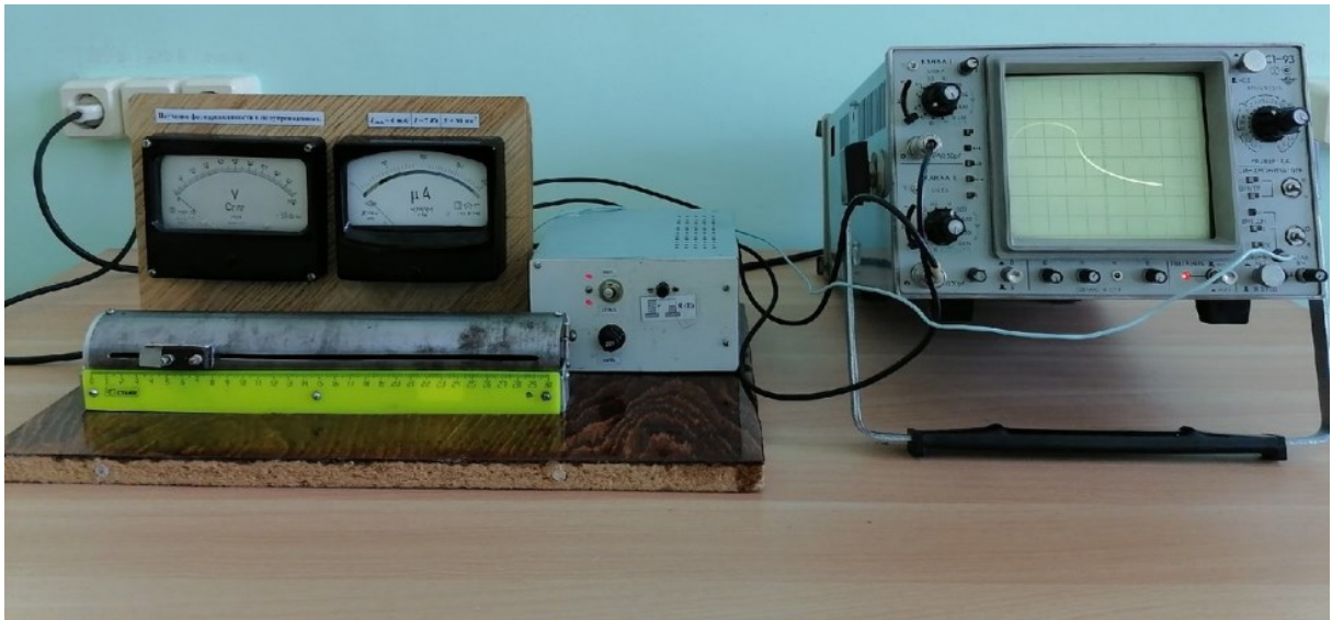
Рис. 1. Экспериментальная установка определения времени жизни носителей заряда
