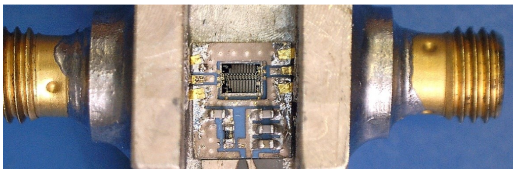
Рис. 1. МОИС МШУ УРУ0918, смонтированная в контактное устройство
