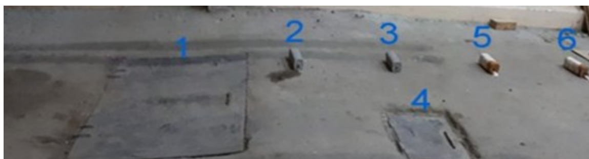
Рис. 5. Расположение образцов поперек движения георадара
