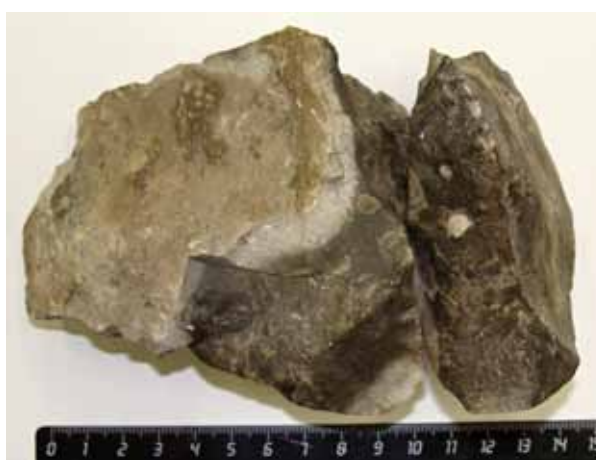
Рис. 2. Фото образца. Окремнение на границе различных структурно-генетических типов известняков
