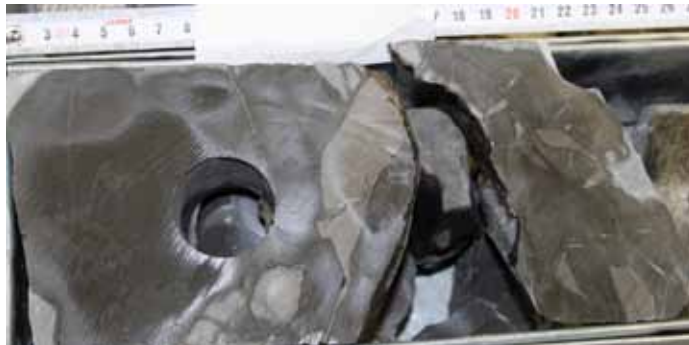
Рис. 3. Известняк с текстурой блокового будинажа, обусловленной наличием крупных обломков доломита в глинистом доломите (филиппзельский горизонт, S_1 )
