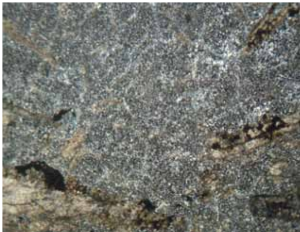
Рис. 3. Фото шлифа. Полное замещение исходной породы агрегатами аутигенного кремнезема
