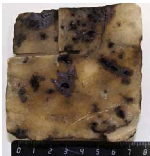
Рис. 5. Фото образца. Вторичное окремнение известняка в зоне древнего ВНК
