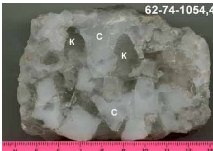
Рис. 3. Сильвин-карналлитовая порода. С — сильвин (гипидиоморфные белые кристаллы), К — карналлит (более тёмные кристаллы)
