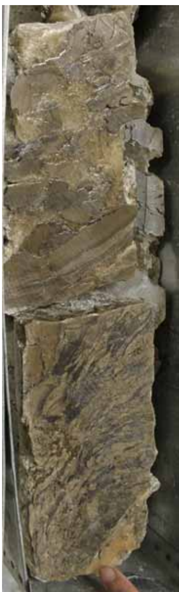
Рис. 4. Тектонические брекчии и складки волочения в керне соленосной толщи малотавротинского горизонта ( O_3 )
