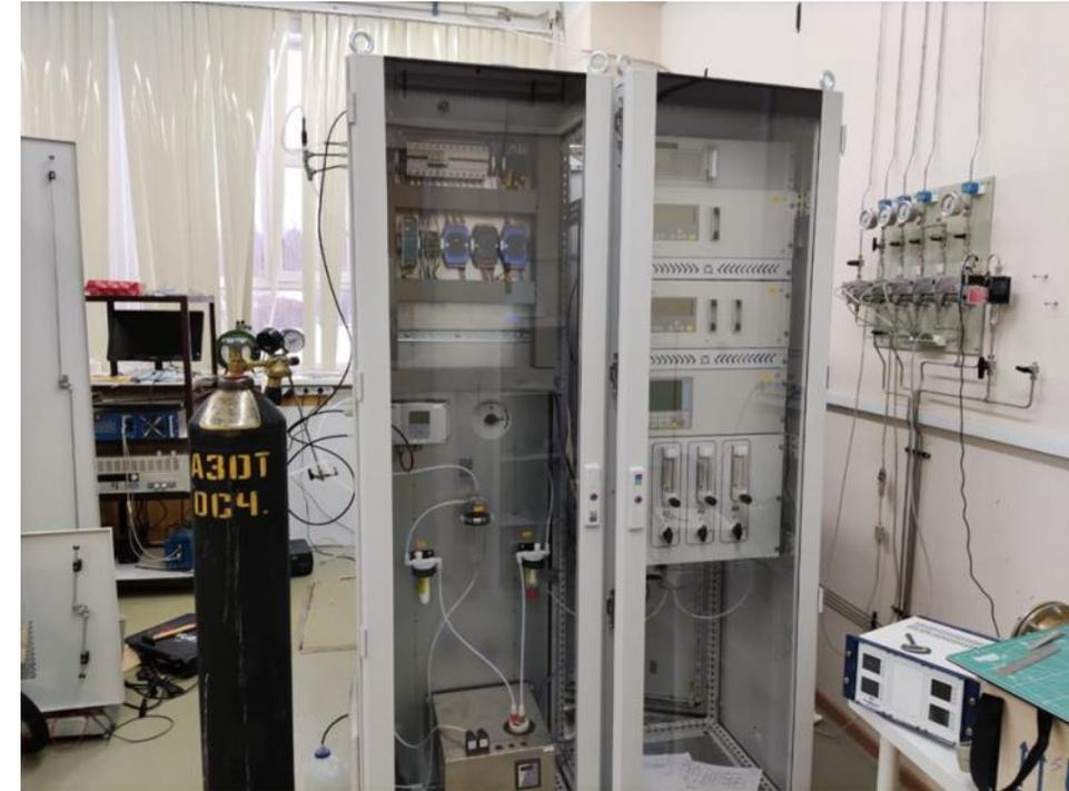
Проточный газовый анализатор Бонэр-ВТ (на базе комплектующих Siemens)
