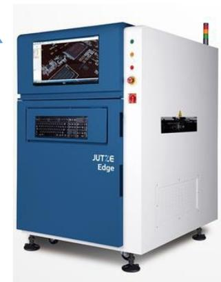
Общий вид системы 3D автоматической оптической инспекции Jutze
