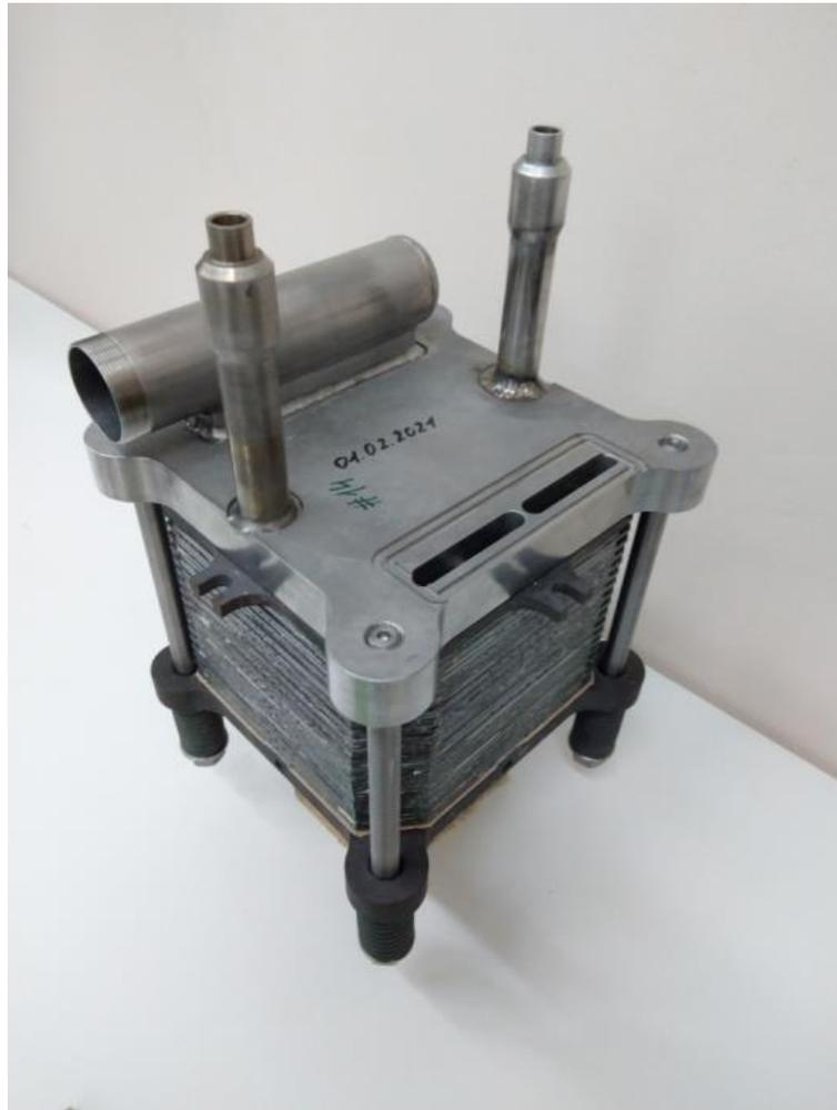
Батарея ТОТЭ с поддерживающим электролитом мощностью 450-700 Вт
