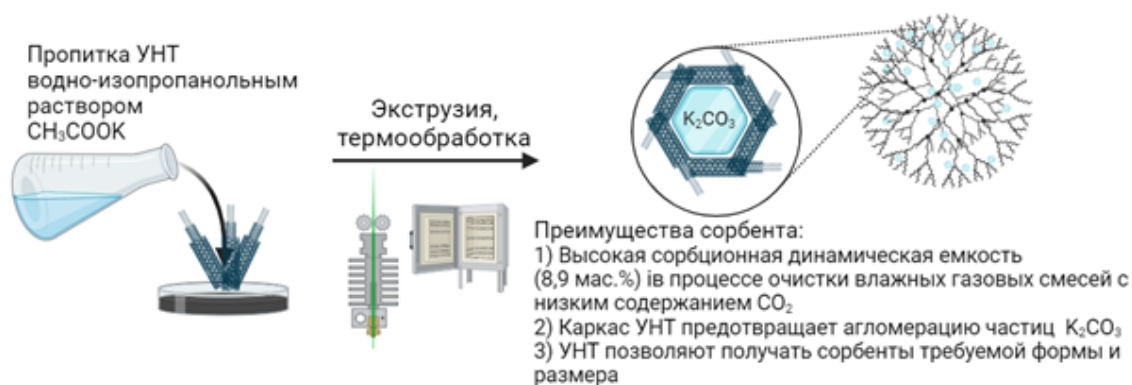
Рис. 1. Схема синтеза и преимущества сорбента \text{K}_2\text{CO}_3/\text{УНТ} .
