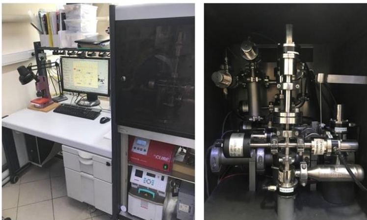
Установка для определения транспортных и разделительных свойств мембранных материалов и мембран
