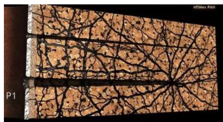
Рис.2. Схема метода направленной разгрузки пласта
