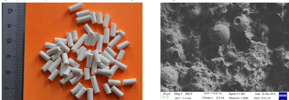
Рис. 2. Фотография гранул композитного сорбента на основе микросфер МС-В-1Л (слева) и снимок скола гранулы с электронного сканирующего микроскопа (справа).
