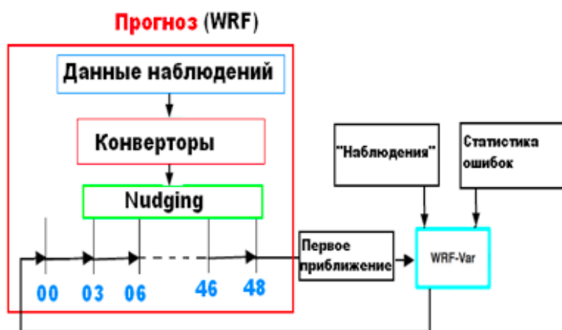
Рис. 10. Схема расчета долгосрочной проекции метеополей моделью WRF
