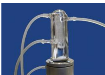
Рис. 1 Ультразвуковая суспензионная колонка (диаметр 10 мм, длина 50 мм, масса сорбента 0,02 г)
