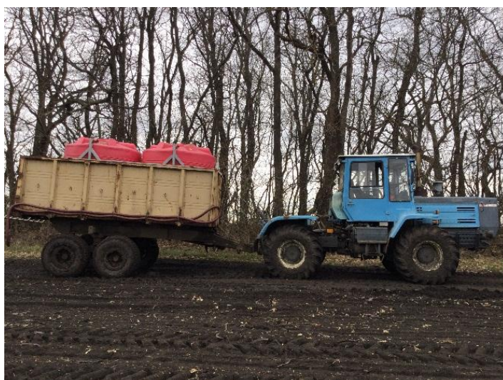
Рисунок 5. Общий вид агрегата с емкостями для ЖКУ
