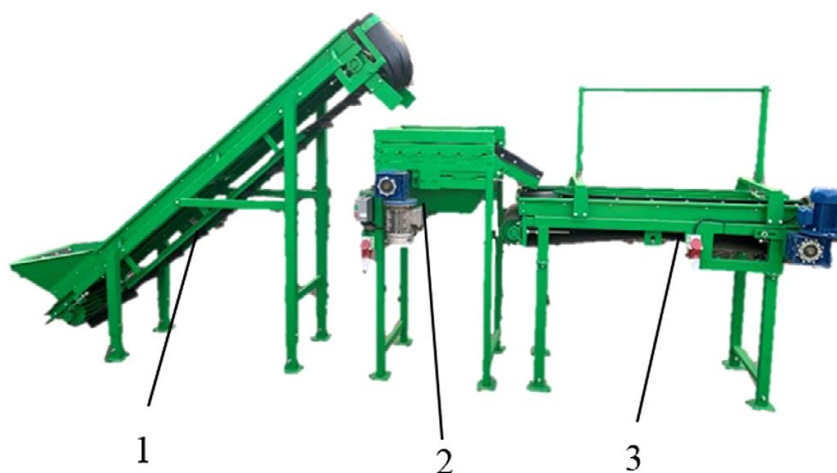
Рисунок 5. Общий вид экспериментальной автоматизированной линии для послеуборочной доработки клубней картофеля (ФГБНУ ФНАЦ ВИМ) (1 – загрузочный транспортер; 2 – отделитель примесей; 3 – переборочный стол)
