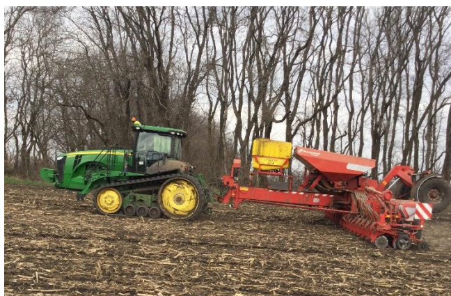
Рисунок 1. Общий вид сеялки точного высева Optima TFmaxi в агрегате с трактором John Deere 8310RT
