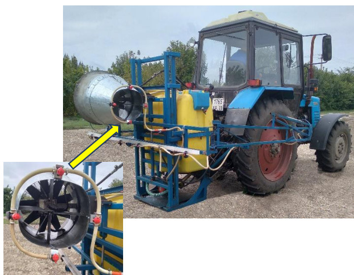
Рисунок 1. Общий вид технического средства с устройством для краевой обработки поля
