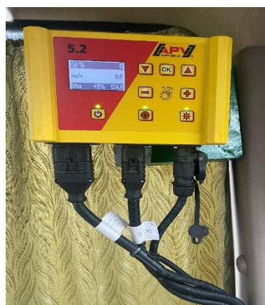
Рисунок 4. Общий вид управляющего модуля 5.2 устройства для внесения ЖКУ LF 600 M1
