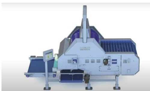
Рисунок 2. Автоматическая опико-электронная установка Oculus
