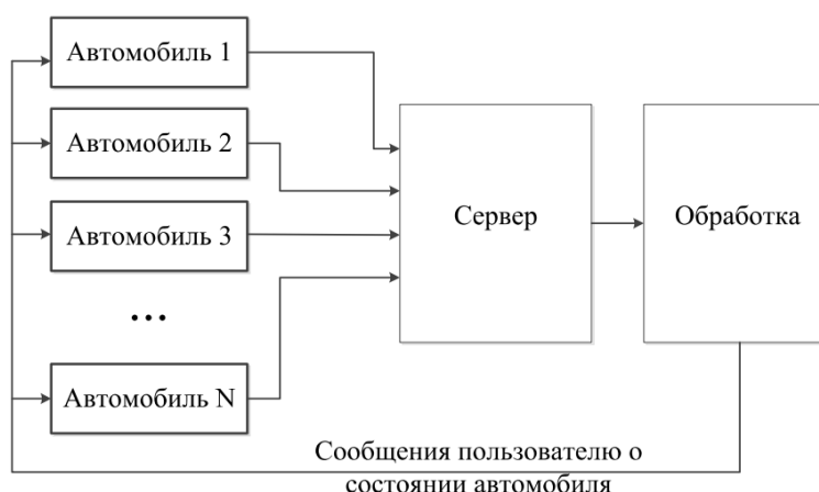
Рисунок 1. Структурная схема дистанционной системы диагностирования автомобиля
