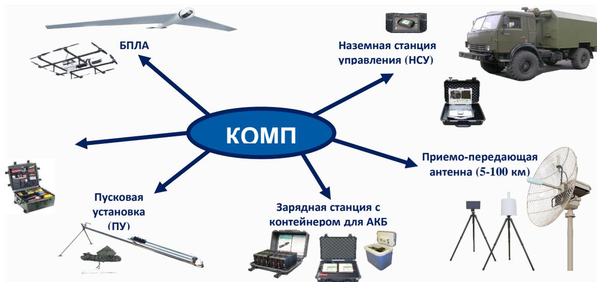
Рис.1. Состав беспилотного комплекса для мониторинга магистральных трубопроводов
