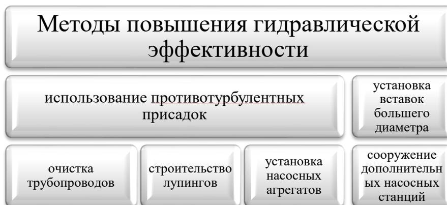
Рис. 1. Методы снижения гидравлических нагрузок
