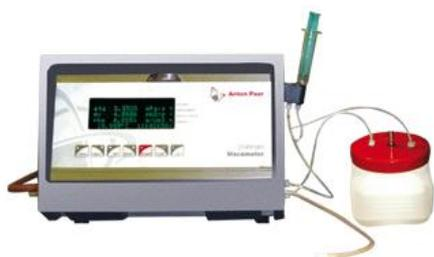
Рис. 2. Вискозиметр Штабингера SVM 3000
