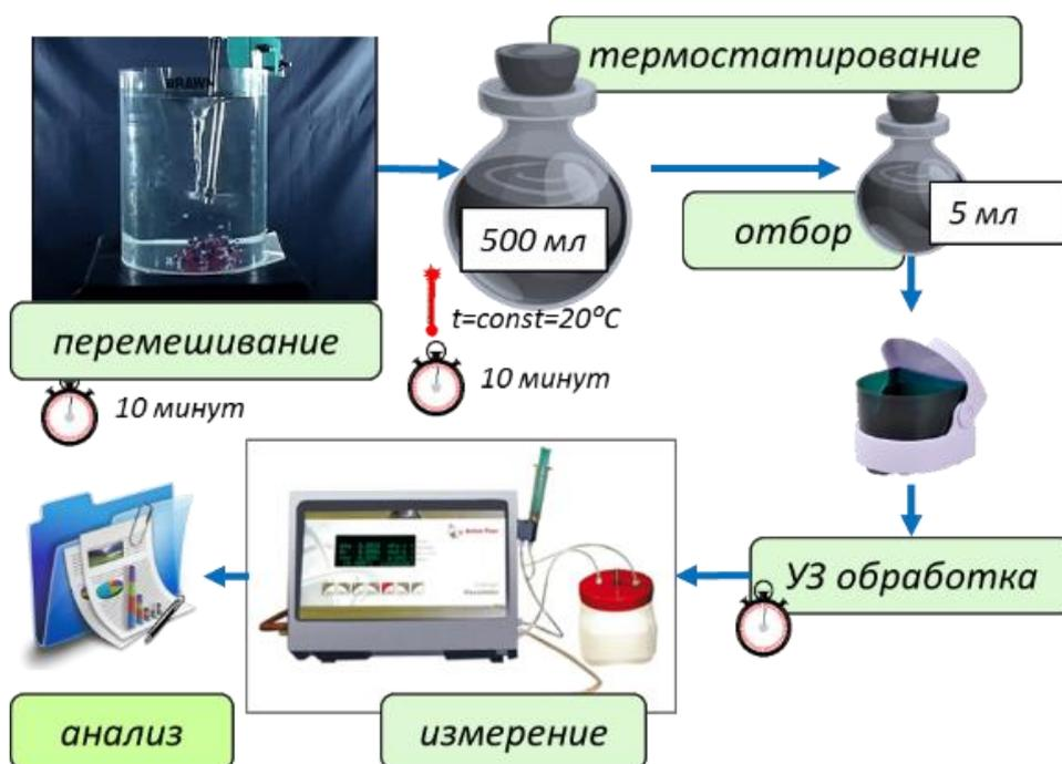
Рис. 4. Методика по УЗ обработки
