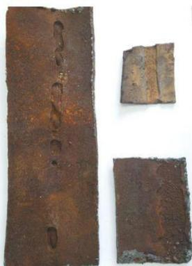
Рис. 1. Ручейковая коррозия
