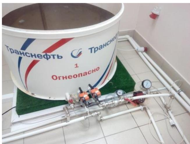
Рис 1. Модель резервуара РВСПК- 10000 с технологической обвязкой
