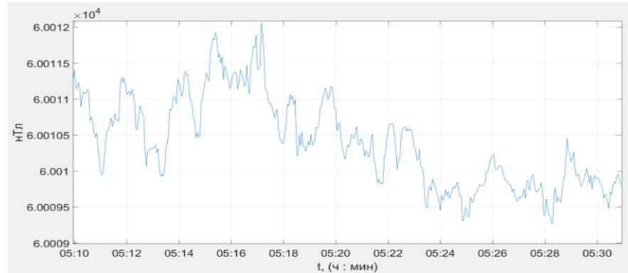
Модуль магнитного поля (кванты) Модуль магнитного поля протонного магнитометра
