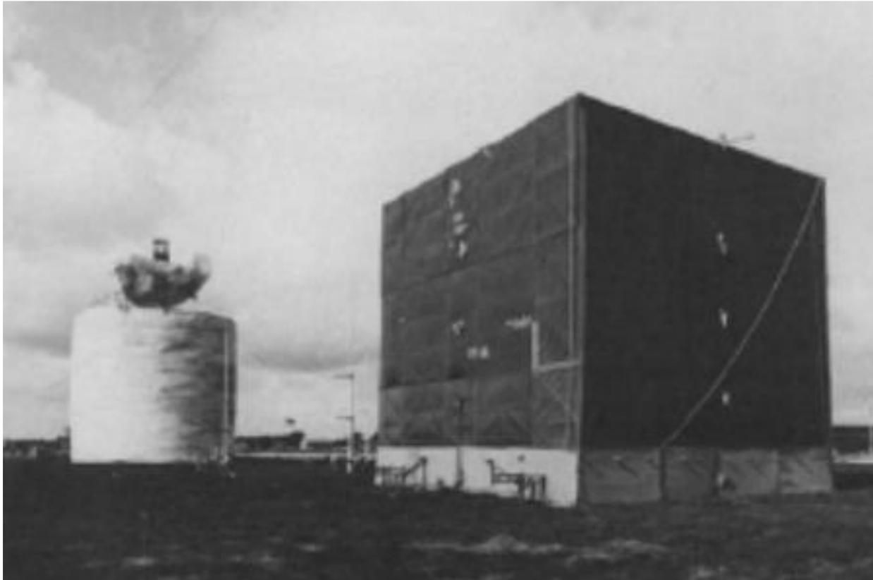
**Натурный эксперимент на острове Тони по исследованию распределения концентрации при обтекании строения после выброса газа из верхнего люка цилиндрического хранилища [1].**
