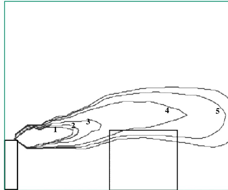
Зависимость концентрации  $\text{кг/м}^3$  и размеров облака вредного выброса от расстояния до места аварии в различные моменты времени [2].
