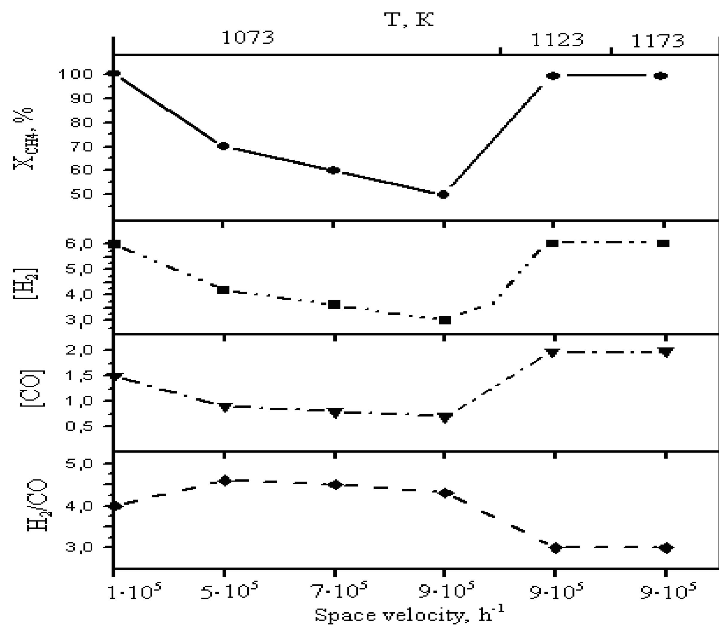
Experimental conditions: SOC of CH<sub>4</sub> : O<sub>2</sub> : H<sub>2</sub>O : Ar = 2.0 : 1.0 : 2.0 : 95.0%, T = 1073 – 1173 K, V = 1·10<sup>5</sup> - 9·10<sup>5</sup> h<sup>-1</sup>
