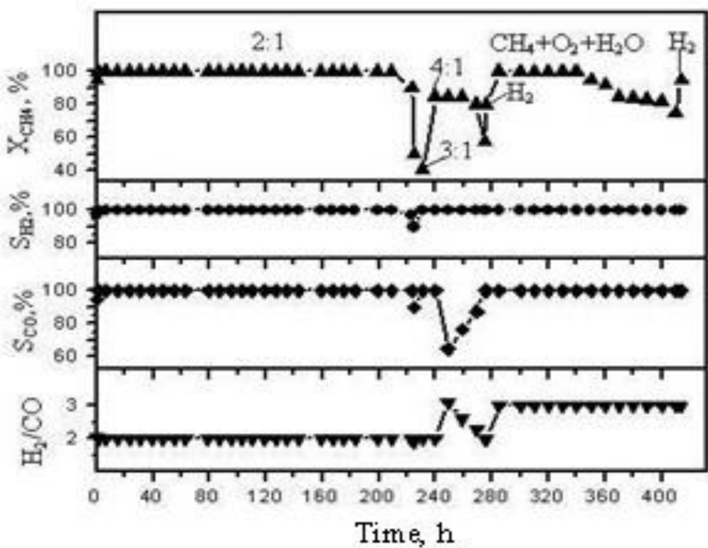
Condition the process of SCO of methane: CH<sub>4</sub> : O<sub>2</sub> : Ar = 2.0 : 1.0 : 97.0, %, T = 1173 K, V = 9·10<sup>5</sup> h<sup>-1</sup>, τ = 0.004 s and SOC of methane CH<sub>4</sub> : O<sub>2</sub> : H<sub>2</sub>O : Ar = 2.0 : 1.0 : 2.0 : 95.0, %, T = 1073 K, V = 1·10<sup>5</sup> h<sup>-1</sup>, τ = 0.036 s
